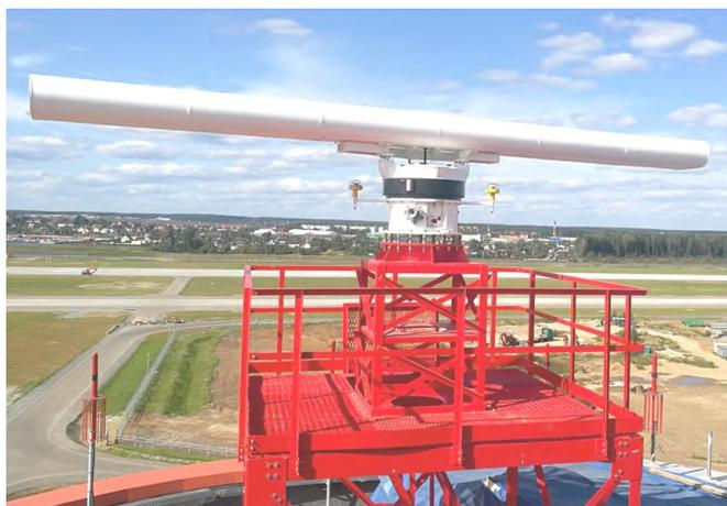
Рис. 2. Узконаправленная волноводная антенна: установка в антенном модуле РЛС ОЛП «Алькор» [7]
