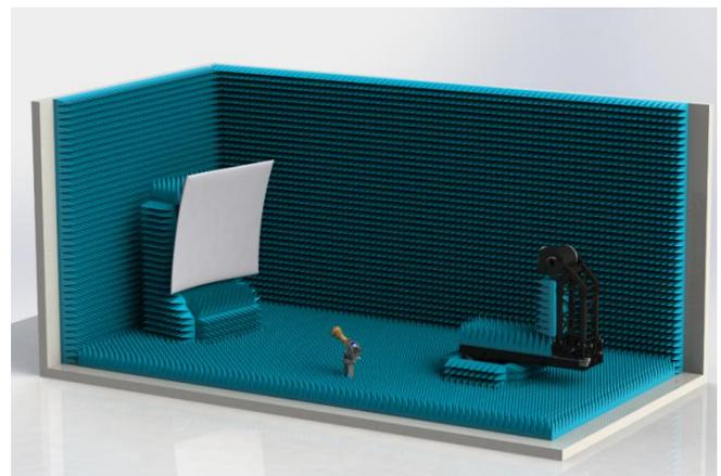
Рис. 1. Комбинированный комплекс для тестирования антенн 5G разработанный компанией Радиолайн: амплитудно-фазовое распределение в тихой зоне коллиматора, частота – 110 ГГц
