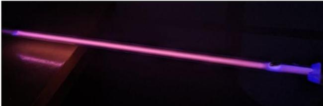
Рис. 6. Тлеющий разряд плазмы с потоком аргона
