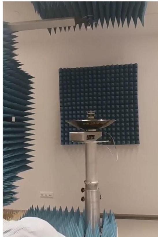
Рис. 3. Антенная система ЗССС на испытаниях
