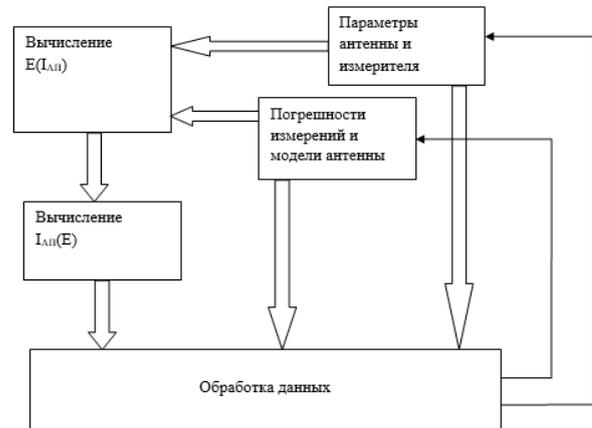
Рис. 5. Схема моделирования реконструкции апертурного распределения
