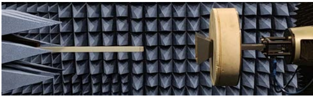
Рис. 1. Установка для экспериментального измерения ближнего поля рупорной антенны
