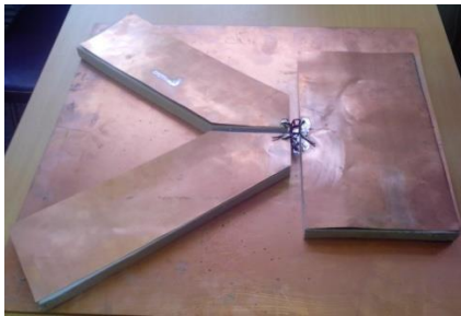
Рис. 6. Фотография макета полоскового мостового ПР
