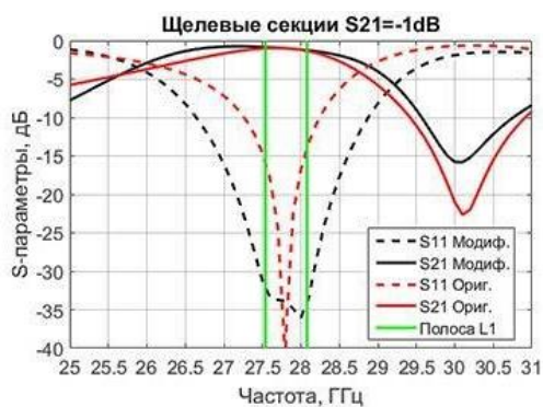
Рис. 2. Сравнение S-параметров щелевой секции при использовании одного и двух реактивных штырей
