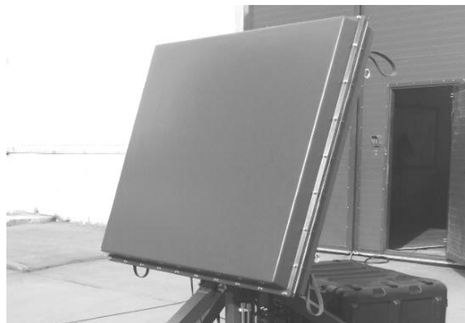
Рис. 1. Фазированная антенная решетка S-диапазона
