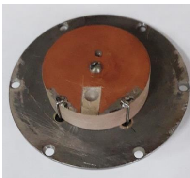
Рис. 11. Экспериментальный макет АОПВ на диэлектрике с \epsilon=9,6 Габариты антенны \phi 43 \times 12 мм
